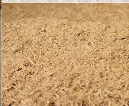
Træet findeles og tørres. Da udtjent træ er tørt, reduceres energiforbruget
